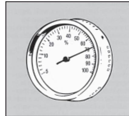
Проверка волосяного гидрометра осуществляется обмоткой корпуса чистой влажной тканью, а затем гидрометр помещается в герметичный контейнер с водой на дне, при этом вода не должна попадать в гидрометр и его капсулу.
