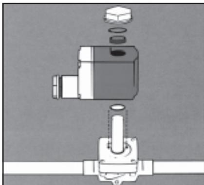
Необходимо правильно снимать крышку катушки. Возьмите крышку большим и указательным пальцами и поверните на половину оборота как при использовании гаечного ключа. Будьте осторожны! Пластиковая крышка может сломаться при переключении.
