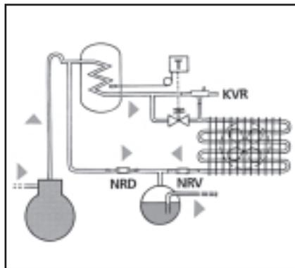
Регулятор KVR может служить заправочным вентилем в холодильных установках с автоматическим размораживанием.
