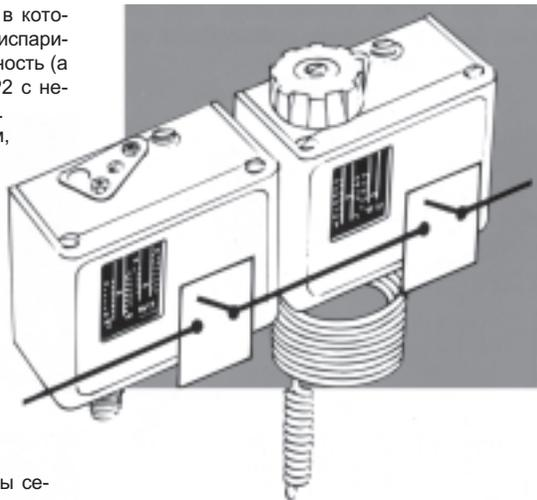
Для установок, в которых прессостаты серии KP работают очень редко (например, для выдачи сигнала тревоги) или выполняют функции датчиков-излучателей для программируемых автоматов типа HLC или им подобных, мы рекомендуем использовать KP с золотыми пластинчатыми контактами. Они обеспечивают надежный контакт при очень низких напряжениях.
