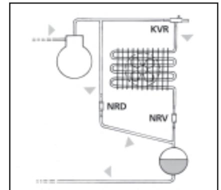
Регуляторы KVR используются также в системах с рекуперацией тепла. В этом случае регуляторы KVR устанавливаются между рекуператором и конденсатором.
