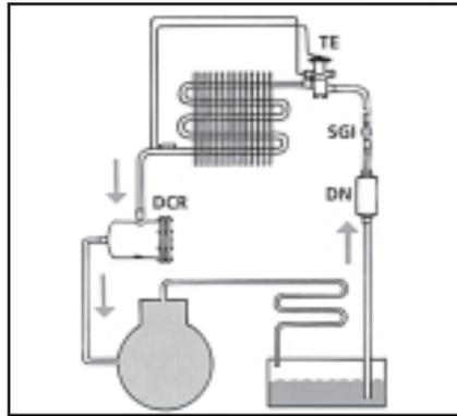
Смотровые стекла с индикатором влажности обычно устанавливаются после фильтра-осушителя, где по цвету и состоянию индикатора можно определить следующие параметры:
