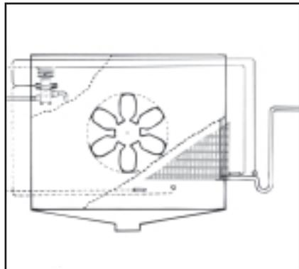
Не устанавливайте капсулу после теплообменника: это может вызвать появление ложных команд в контуре регулирования.
