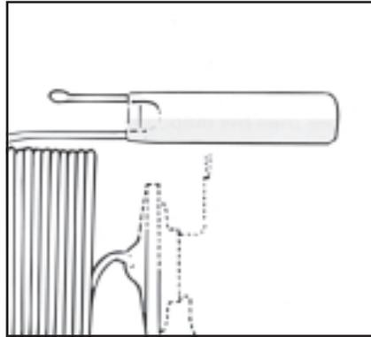
**ТРВ с заправкой MOP** используются в моноблочных агрегатах, в которых при запуске желательно ограничивать давление всасывания (авторефрижераторы, воздушные кондиционеры).
