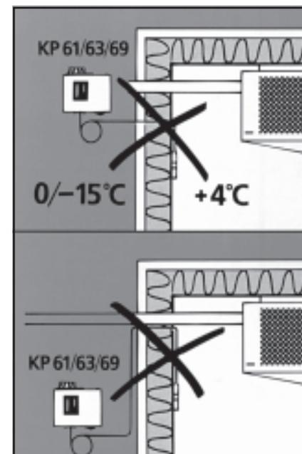
Капиллярные трубки термостатов с паровым наполнением и всасывающие трубопроводы никогда не должны проходить сквозь стены!
