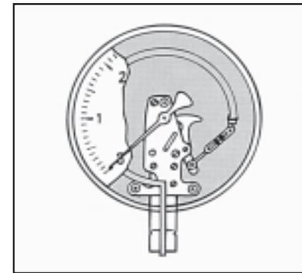
Как правило, сервисные манометры снабжены одной или несколькими шкалами для определения температуры насыщения для обычных хладагентов. Манометр должен иметь доступный винт регулировки нулевой точкой, поскольку трубка Бэрдона может просесть (become set) при длительном воздействии высокого давления. Манометры необходимо регулярно проверять по отношению к более точному оборудованию. Ежедневная проверка должна подтверждать, что манометр показывает 0 при атмосферном давлении.
