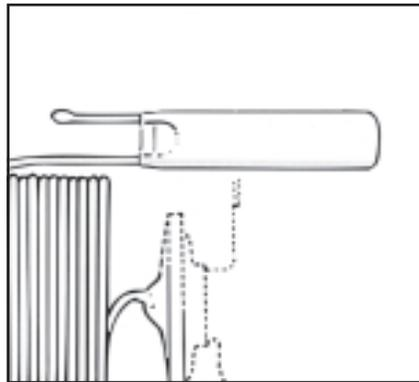
**ТРВ MOP с наполнителем** предназначены для холодильных установок, имеющих высокдинамичные испарители, например, воздушных кондиционеров, или для пластинчатых теплообменников с высокой интенсивностью теплопередачи. MOP с наполнителем обеспечивает работу при перегреве на 2-4°K ниже, чем это достигается с другими типами заправки.
