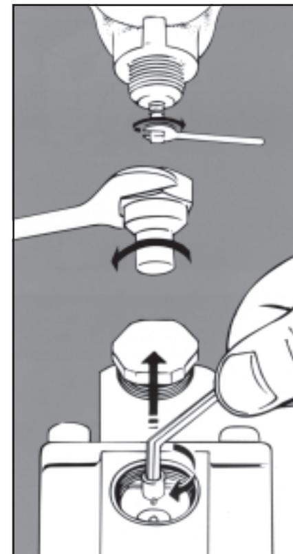
Всегда воздействуйте компенсирующим усилием при окончательном затягивании гаек крепежа клапана на трубах, например, размещая второй гаечный ключ с другой стороны клапана.
