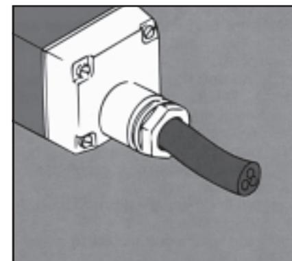
Определите значение цвета проводов. Желтый/зеленый цвет всегда обозначают цепь заземления. Другие цвета проводов обозначают фазу или нейтраль (нулевой провод).
