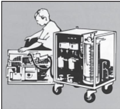
Гибкие шланги для R134a также должны иметь повышенную герметичность. При монтаже и демонтаже специальные быстроразъемные соединения обеспечивают сохранение в шлангах хладагента. Весь инструмент, используемый при техническом обслуживании установок на R134a и эфирных маслах, должен иметь соответствующую маркировку. Эту оснастку и набор принадлежностей рекомендуется использовать только для работы с R134a.
