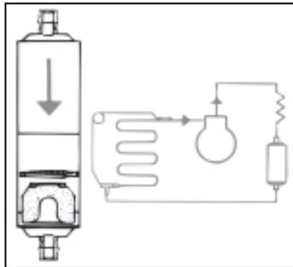
«Прогарный» фильтр 48-DA применяют после выхода из строя герметичных и полугерметичных компрессоров.
