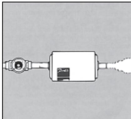
Таким образом, индикация как полного количества влаги в холодильной системе, так и состояния хладагента перед расширительным клапаном может быть определена при условии, что смотровые стекла установлены по обе стороны фильтра-осушителя. Точка перехода от зеленого цвета к желтому на индикаторном смотровом стекле определяет степень поглощения влаги хладагентом.
