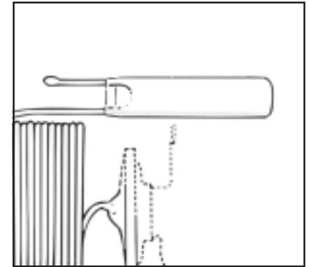
**При заправке MOP с наполнителем** внутри капсулы содержится материал с высокой пористостью, т.е. с большим отношением поверхности к массе. Этот наполнитель создает демпфирующий эффект при регулировке, обеспечиваемой ТРВ: медленное открытие вентиля во время повышения температуры капсулы и быстрое закрытие при понижении. MOP обычно переводят также как «Motor Overload Protection», т.е. «Защита двигателя от перегрузки».
