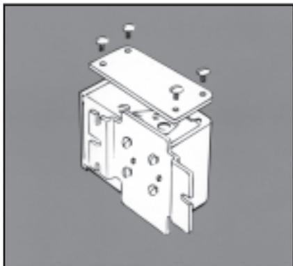
В случае установки термостатов в сильно загрязненных местах или чересчур влажных (брызги воды сверху и со всех сторон) помещениях, термостаты защищаются специальными кожухами (№ 060-1564 для простых моделей и № 060-1565 для двойных), которые приспособлены для углового и настенного крепления.
