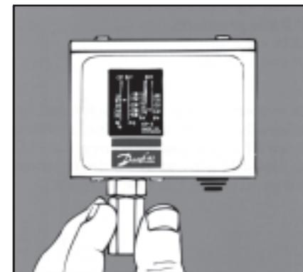
Для холодильных установок со значительной заправкой часто требуется соответствующая безопасность эксплуатации. В этом случае используйте модели КР7/17 с двумя сильфонами: если один ломается, контур останавливается без потерь заправки.
