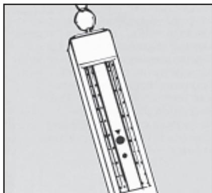
При низкой температуре и высокой влажности разница в температурах мокрого и сухого термометров становится незначительной. В этих условиях использование психрометра увеличивает погрешность, и поэтому целесообразно использование подходящего гидрометра или одного из электронных гидрометров.
