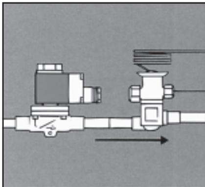
Если гидроудар происходит при закрытии соленоидного клапана, то его можно компенсировать установкой вертикальной Т-образной трубки перед соленоидным клапаном.
