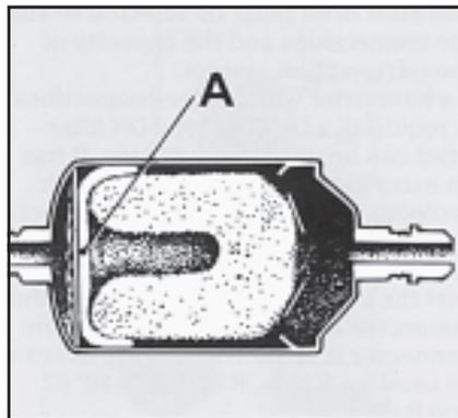
Твердый сердечник обладает большими возможностями для поглощения воды и сохранения накопленной влаги. Молекулярное сито и силиконовый гель задерживают воду, а активированная окись алюминия - воду и кислоты. Твердый сердечник В совместно с полистироловой губкой А действует так же как фильтр от загрязнений. В твердом сердечнике накапливаются большие частицы грязи, в полистироловой губке - малые.
