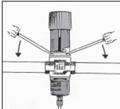
Если в работе клапанов замечены неполадки или в их седлах возникла негерметичность, клапаны следует разобрать и очистить. Перед разборкой необходимо выровнять давление в корпусе сильфона, для чего нужно отсоединить от него трубку, ведущую к конденсатору холодильной установки. После этого следует завернуть вправо до отказа регулировочный винт, чтобы снизить до минимального давление настройки. При разборке необходимо поменять кольцевые прокладки и другие детали.
