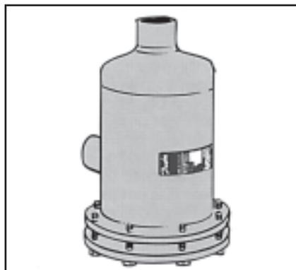
После замены компрессора и очистки системы устанавливаются два «прогарных» фильтра, один - в жидкостной магистрали и один - во всасывающей магистрали.
