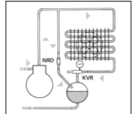
Если конденсатор с воздушным охлаждением и баллон-накопитель размещены снаружи в замороженной среде, могут появиться трудности с повторным запуском установки после продолжительной остановки.
