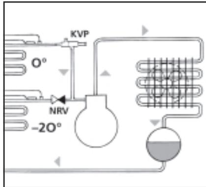
В установках с запараллеленными испарителями и общим компрессором регулятор KVP устанавливают на всасывающей магистрали, чтобы поддерживать в испарителях одинаковое давление.
