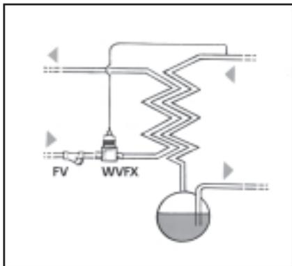
Клапаны WVFM и WVFX 32-40 устанавливаются таким образом, чтобы корпус сильфона был наверху.
