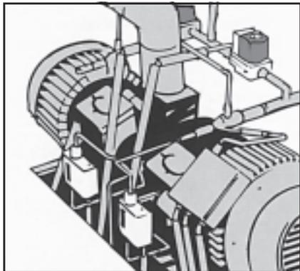
При замене R12 на R134a необходимо поменять главным образом терморегулирующий вентиль и влагоотделитель. Сначала установку следует тщательно очистить от минерального масла, используя при этом специальный промывочный агрегат. Затем заполнить компрессор эфирным маслом марки, рекомендованной разработчиком компрессора.
