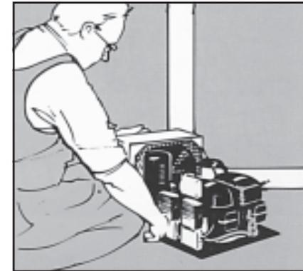
В мастерской, на складе и в ремонтном автомобиле необходимо разложить оборудование, компрессоры и инструмент таким образом, чтобы не допускать совместного хранения изделий, предназначенных для работы с разными хладагентами.
