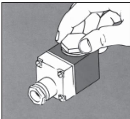
Будьте осторожны с кабельным вводом! Вода не должна проникать в клеммную коробку. Кабель необходимо монтировать с образованием петли для стекания капель жидкости.
