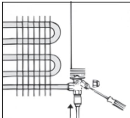
Начиная с TE5, полный оборот винта дает температуру перегрева около  $0,5^\circ\text{K}$  при температуре испарения  $0^\circ\text{C}$ . Начиная с TKE3, полный оборот винта дает изменение перегрева примерно на  $3^\circ$  при температуре испарения  $0^\circ\text{C}$ .
