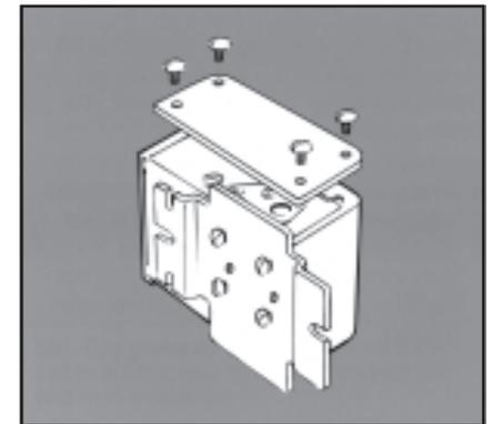
В случае установки прессостатов в сильно загрязненных или чересчур влажных помещениях (брызги воды сверху и со всех сторон) прессостаты защищаются специальными кожухами и (номер кода 060-1564 - для простых моделей и 060-1565 - для сдвоенных), которые приспособлены для углового и настенного крепления.
